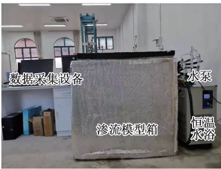
(a) 复合能源地下结构协同传热缩尺实验台
