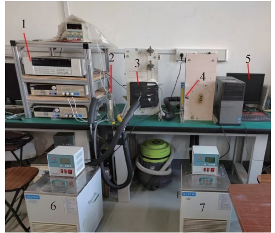
1 数据采集仪;2 转子流量计-热水;3 绝热仓; 4 转子流量计-冷水;5 计算机;6 热源;7 冷源。
