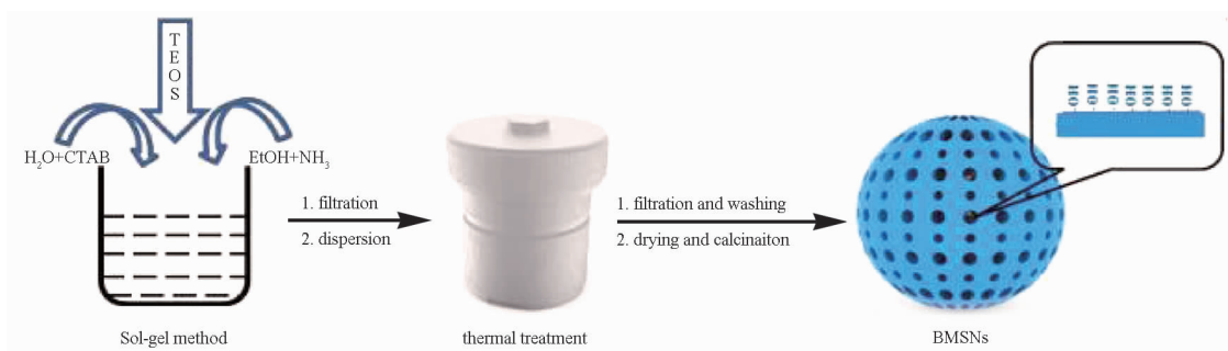
图1 双介孔二氧化硅纳米球(BMSNs)的制备示意图
