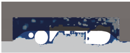
(a) 转向架周围雪粒分布侧视图
