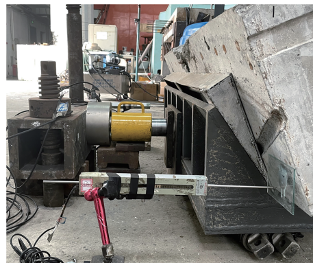
(c) 千斤顶水平方向施加轴向力
