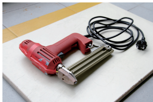
图3 改造后的安全电动射钉枪实物
