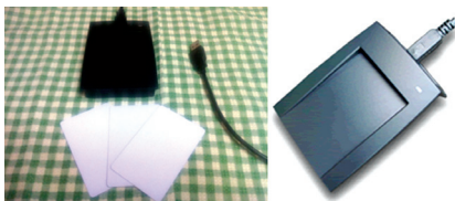
图1 射频卡及读写机 左上方的是射频卡读写机，学生可以利用读写机将射频卡上的资料读进系统内。
