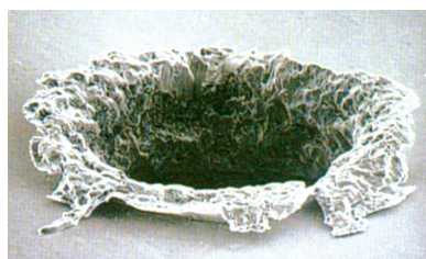
油漆碎片撞击航天飞机舷窗的后果
