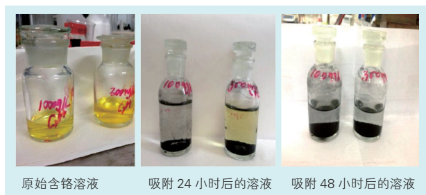
图 4 多孔炭对铬离子吸附能力实验结果
