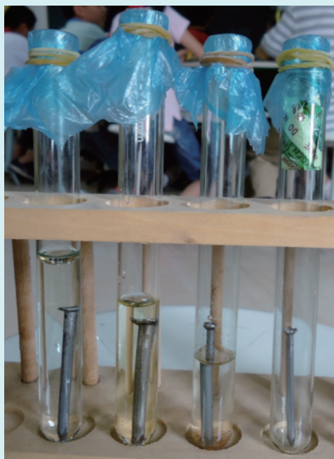
把4根同样的铁钉分别放置在封植物油的蒸馏水中、植物油中、一部分自来水中、有干燥剂的空气中。1周后呈现的实验结果分别为:铁钉未生锈;铁钉未生锈;铁钉生锈了,且在空气和水都比较充足的水面生锈最严重;铁钉未生锈。
