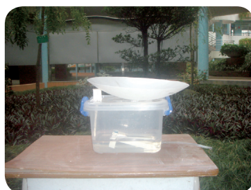
图2 处于供水状态的集雨器实物
