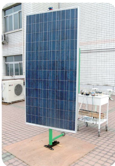
图2 自动跟光太阳能板演示装置实物
