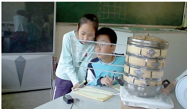
学生在测量蒸笼内的温度，每隔1分钟记录1次4个笼内的温度，边测量边记录
