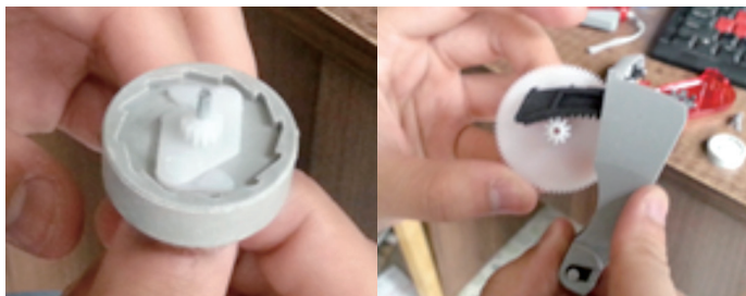
图2 双面反向式超越离合器及齿轮齿条装置
