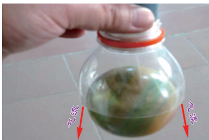
图5 演示小球停留在倒置漏斗中
