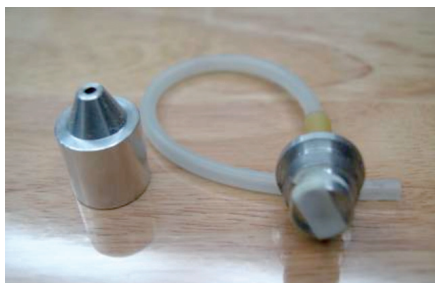
图3 改进后的机械人工喉装置
