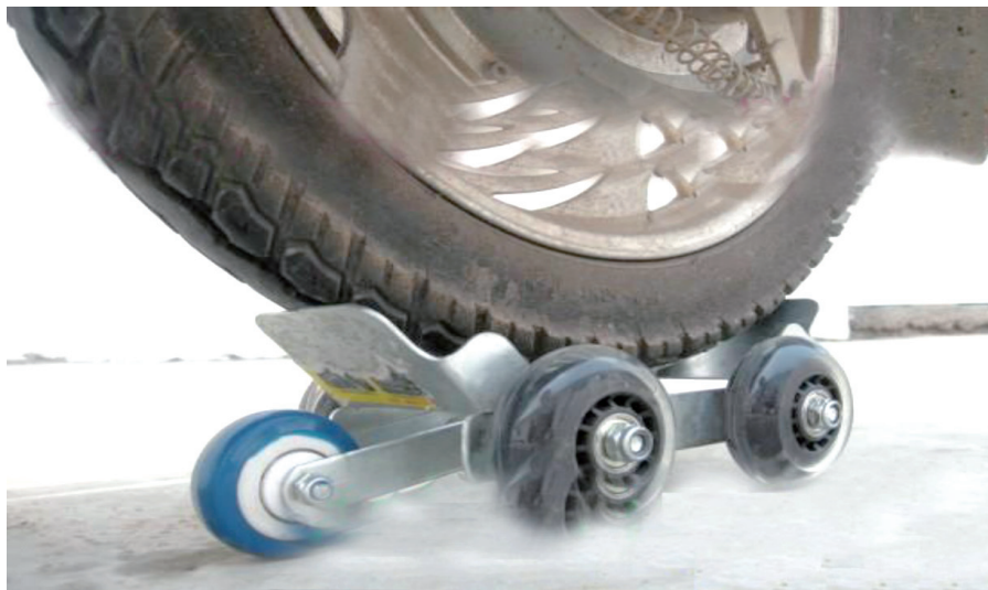
图1 五轮式爆胎保护装置
