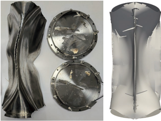
图 7 试验残骸与数值模拟中的结构变形
