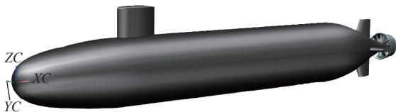
图 3 DARPA Suboff 潜艇-泵喷推进器组合模型
