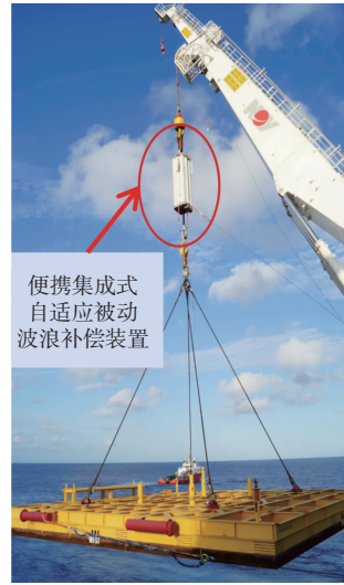
图2 Safelink AS公司便携集成式波浪补偿装置 [12]
