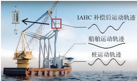
图 13 海上风机整体式安装法 [44]
