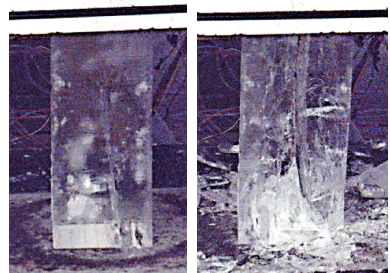
(b) 纵向贯穿破坏示意图
