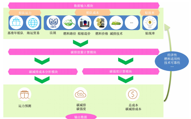
图1 船队温室气体减排分析模型架构
