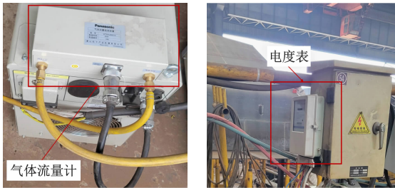
图 7 焊接作业部分测量设备
