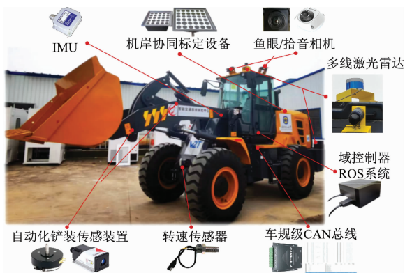
图 2 清舱机器人硬件系统
