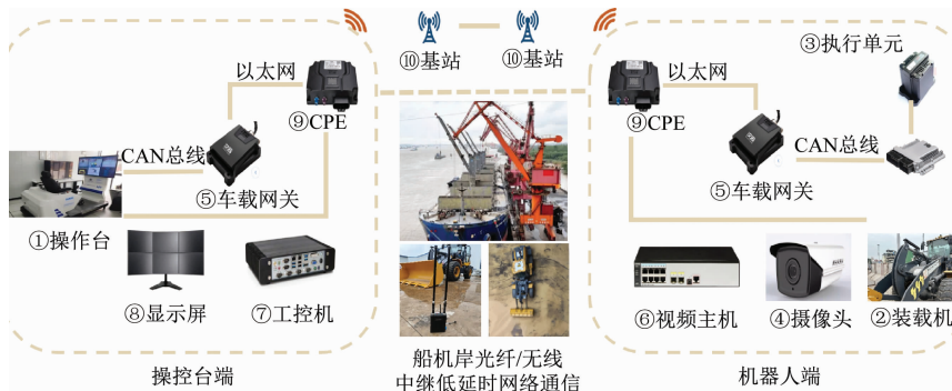
图5 船机岸通信系统
