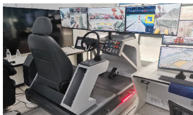
图 4 沉浸式云控驾驶台
