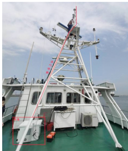
图3 避免海巡艇自身尾气干扰的进气口安装要求
