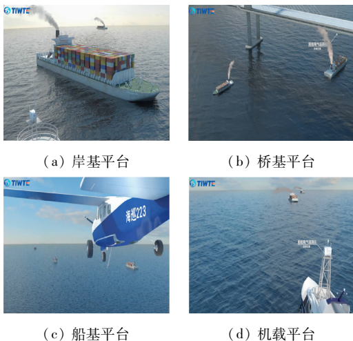
图6 嗅探法应用的2种固定平台(岸、桥)和2种移动平台(船、机)
