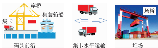
图1 典型集装箱码头装卸工艺
