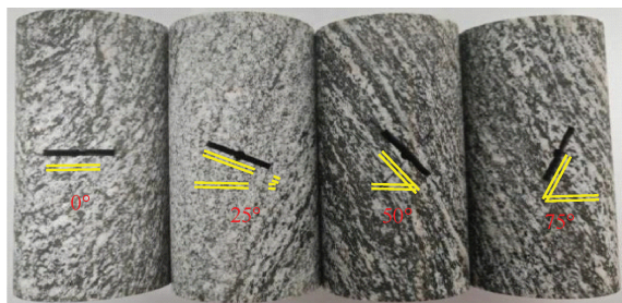
图2 预制不同倾角裂隙的边坡岩样
