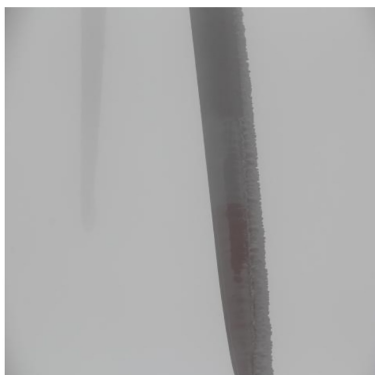
图5 邻近2号机组叶片覆冰严重
