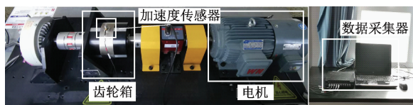
图 3 齿轮箱故障模拟试验台 Fig. 3 Gearbox fault simulation test bench
