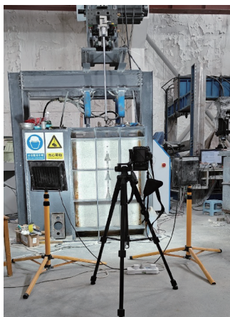
图 2 可视化三向加载拉拔试验装置
