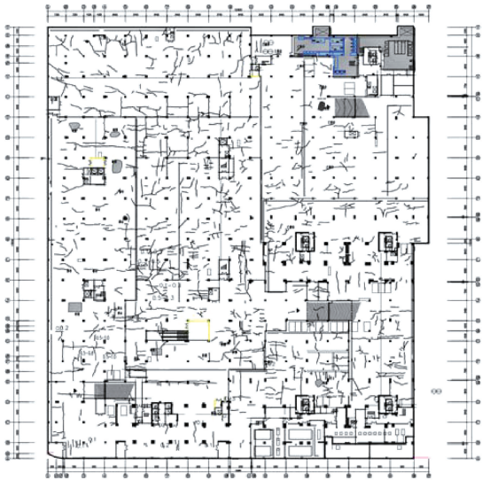
图 4 地下室底板裂缝分布
