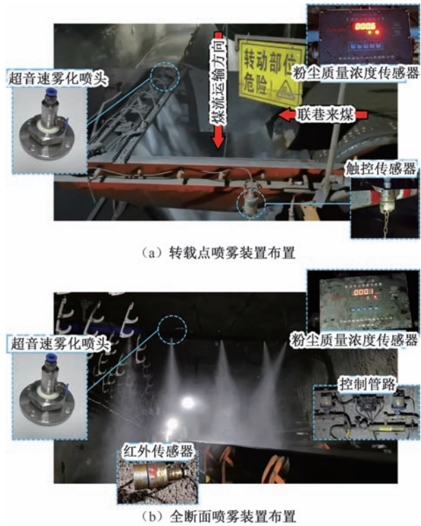
图 11 多断面喷雾装置布置
