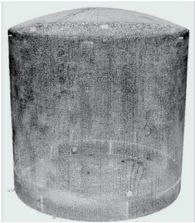
图7 储罐3D检测点云预处理模型
