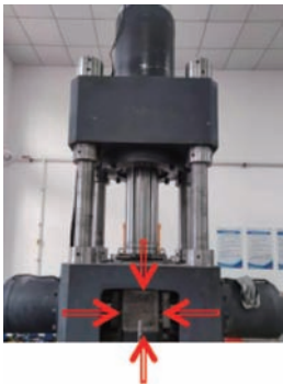
图 3 应力加载方式 Fig. 3 Stress loading method
