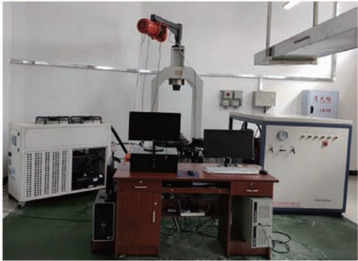
图 1 瓦斯水合固化与力学性质测试一体化装置
