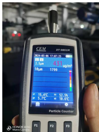
图 10 输煤系统现场粉尘实测情况
