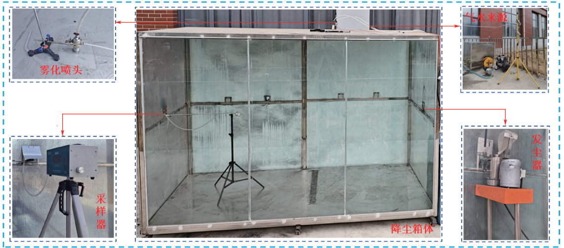
图10 雾化降尘试验平台
