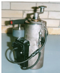
图1 滚筒翻滚系统和便携式气体分析仪
