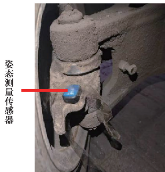
(b) 转向桥传感器布置
