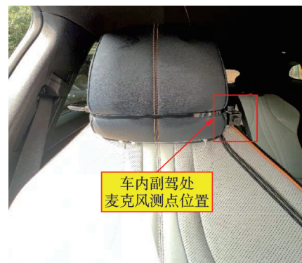
图14 车内副驾麦克风测点位置示意图
