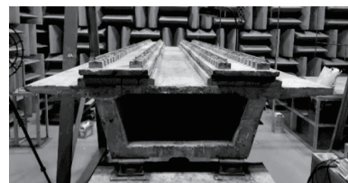
图 1 轨道-桥梁结构模型
