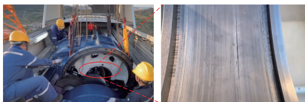
图 11 风机齿轮箱轴承室磨损故障
