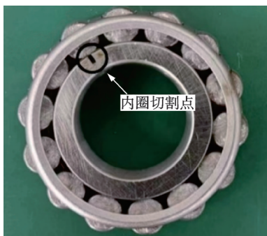
图25 内圈故障轴承
