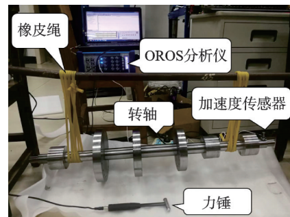
图 6 转子的自由-自由模态试验 Fig. 6 Modal test of rotor in free-free condition
