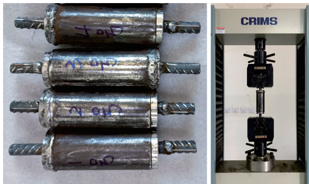
图 5 钢筋接头力学性能试验
