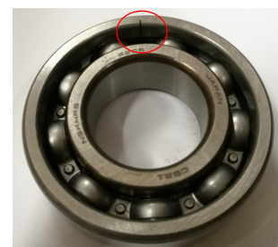
图 11 外圈裂纹故障轴承
