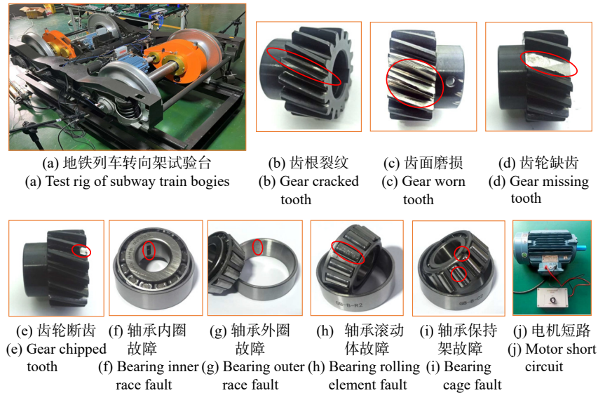
图4 地铁列车牵引传动系统试验台与九种故障状态
