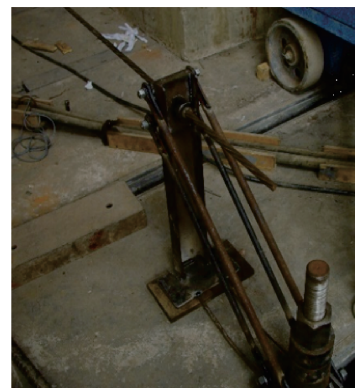
(d) 反力架锚固端 (d) Anchor end of reaction frame
