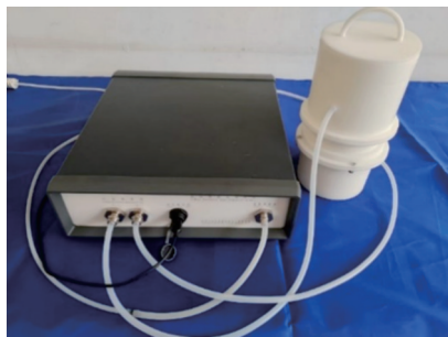
图 4 稳态流阻测量系统实物图
