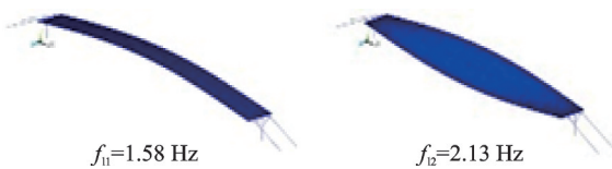
图 2 原型前两阶自振频率及振型
